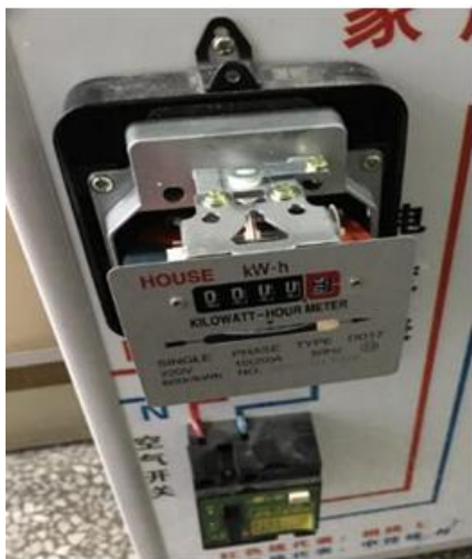
图1 改装后的家庭电路电能表正面
